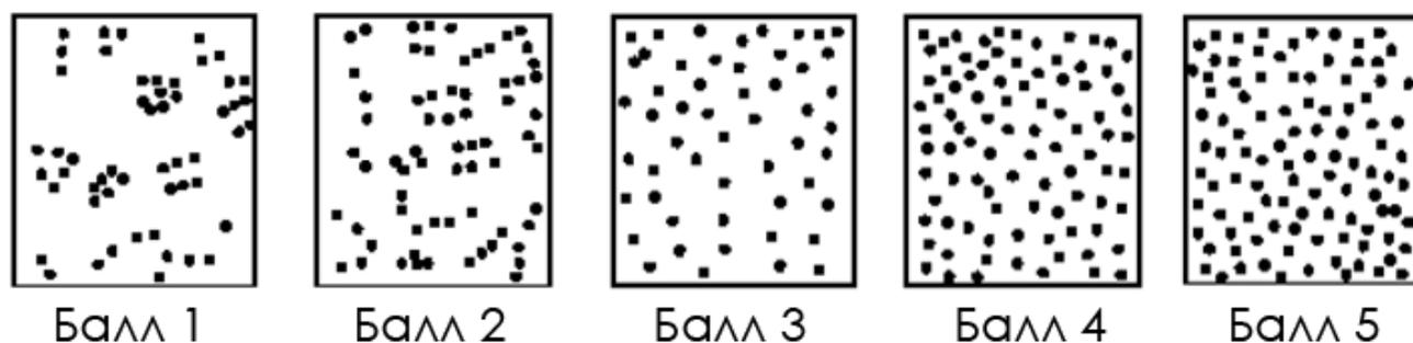
Рисунок Б.1. Шкала пористости алюминиевых сплавов
