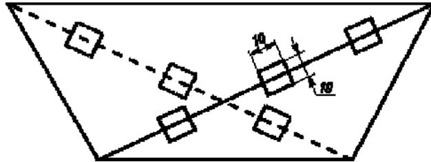
Рис.Б.2. Схема расположения квадратов на микрошлифе
